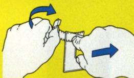
片方の手で切り取ったパーツを持ちながら、定規などをあてて反対方向に滑らすと、パーツにキレイなアールができます。小さなパーツは、竹串などを芯にしてパーツを巻き付け、コヨリをつくる要領で指を左右に動かします。イラストの青色の線は、すべてアールを付ける線です。
