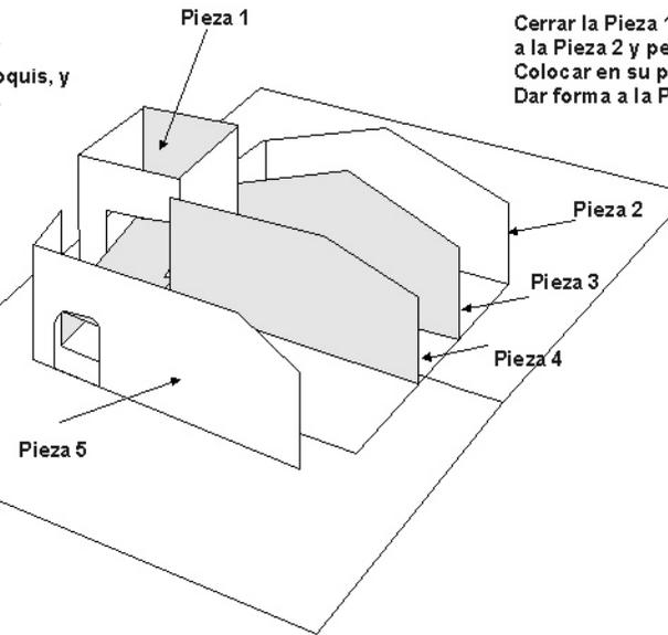
Cerrar la Pieza 1 sobre sí y pegarla sobre la base. Dar forma a la Pieza 2 y pegarla sobre la base y contra la pieza 1. Colocar en su posición los apoyos interiores, Piezas 3 y 4. Dar forma a la Pieza 5 y pegarla contra la pieza 1 y sobre la base.
